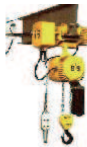
Elétrica com deslocamento motorizado e botoeira de comando
